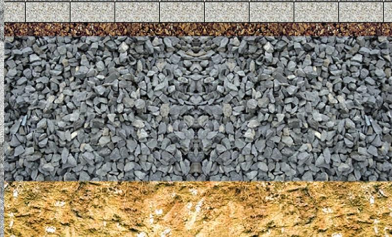
Les pavés **hydroPAVERS<sup>MC</sup>** peuvent absorber jusqu'à 6,35 mm d'eau de pluie. Une fois le substrat saturé d'eau, l'excédent s'écoule dans la couche granulaire et les strates sous-jacentes à un débit de 38 mm la minute.
