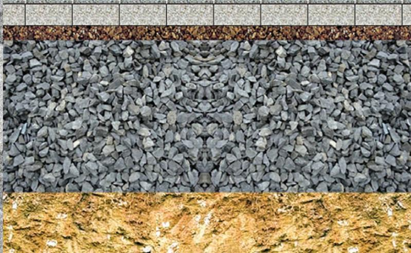
Nuestros **hydroPAVERS™** pueden retener el agua de un evento de lluvia de ¼" hasta saturarse, luego el agua de lluvia sigue drenando a través del bloque y a la base de agregado y sub-base a una razón de 1½" de agua/minuto.
